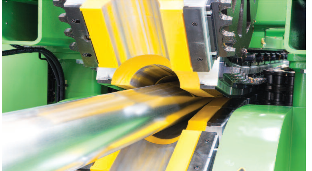
Tek bir kaynaktan şekillendirme, kaynak ve ekstrüzyon gibi temel işlemler. Rosendahl Nextrom'un RH-W üretim hattı.
